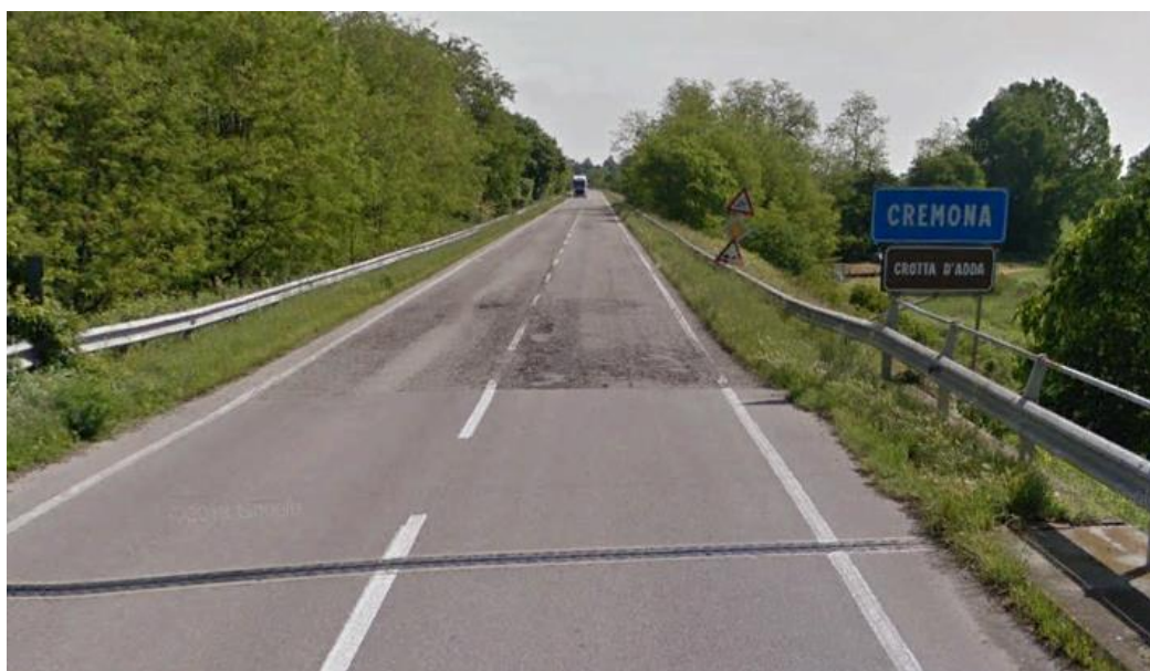
Area da delimitare con new jersey, ingombro massimo una corsia e render semaforizzata h24 previo nullaosta della Provincia di Cremona
